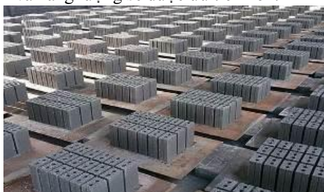
Gạch không nung là một trong những vật liệu xây dựng xanh tiêu biểu nhất hiện nay
